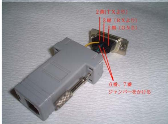
USB→RS232C変換器接続
